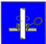
Überprüfen Sie regelmäßig den Zustand aller Dichtungen an Den Druck beaufschlagten Bauteilen
