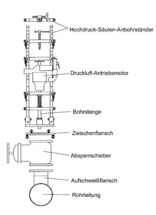
Der Säulen-Anbohrständer wird mittels Fußflansch an der Absperrarmatur angeflanscht.
