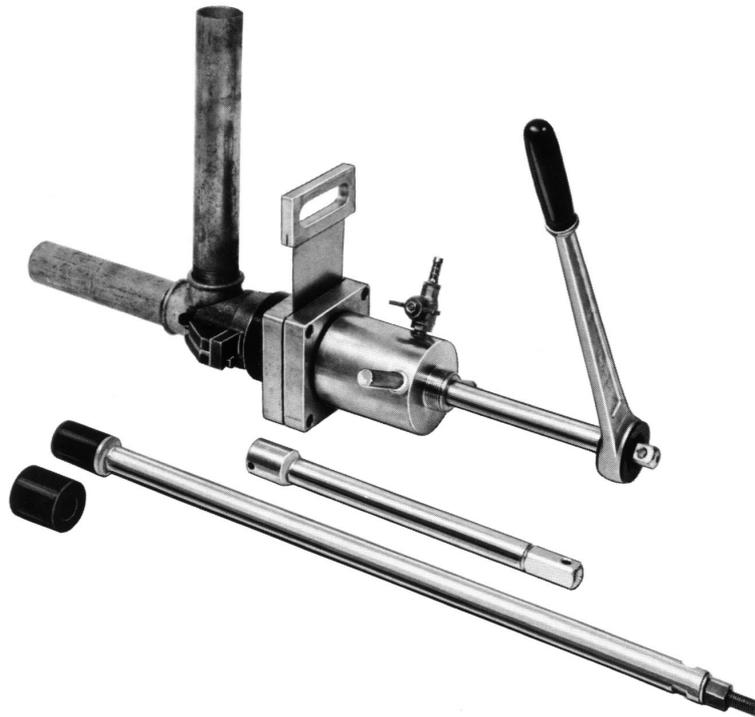
Auf das Reinigungs-T-Stück der Hauseinführung wird eine Schleuse montiert. Die Schleuse besteht aus Klemmvorrichtung und Spachtelschieber. Über den Anbohrdom wird der Reinigungsstopfen gelöst bzw. gesetzt, sowie ein Preßkolben oder die Blasensperrstange in die gasführende Zuleitung eingebracht und somit die Zuleitung gesperrt. Hierdurch ist es möglich den Gashauptahn oder auch das T-Stück ohne Gasaustritt zu wechseln.
