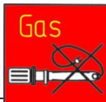
Verwenden Sie bei Arbeiten an Gasleitungen keine Elektroantriebe, die nicht EX-geschützt sind.
