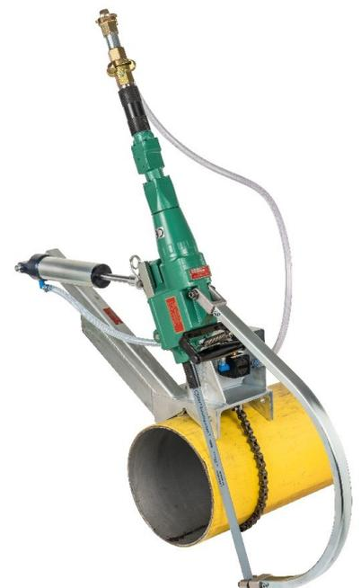
an die Säge montieren. (siehe hierzu Gebrauchs-anleitung Sticksäge). Ggf. Vorschubbügel montieren.
