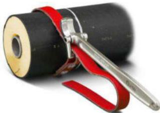
Mit Hilfe des Spannschlüssels angezeichnete Länge des zu trennenden Freischnitts, welche der Verbindungsart der Rohrenden entspricht.
