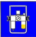
Achten Sie darauf, dass die Druckluftantriebe immer ausreichend und mit dem richtigen Öl versorgt werden!
