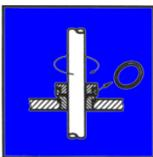
Überprüfen Sie regelmäßig den Zustand aller Dichtungen an Den Druck beaufschlagten Bauteilen
