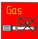
Verwenden Sie bei Arbeiten an Gasleitungen keine Elektroantriebe, die nicht EX-geschützt sind.
